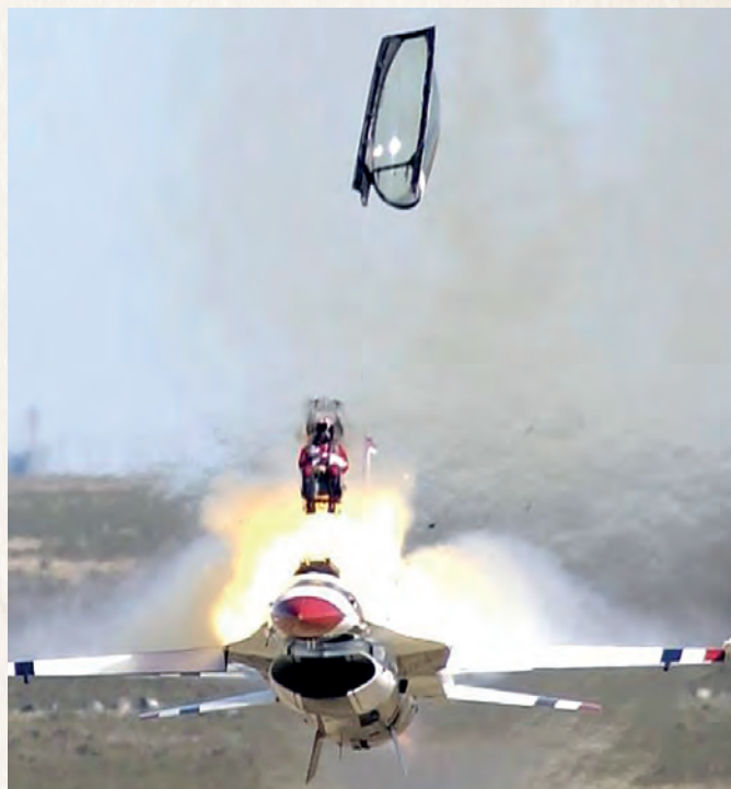
Afwerpen van canopy gevolgd door uitschieting bij F-16.
