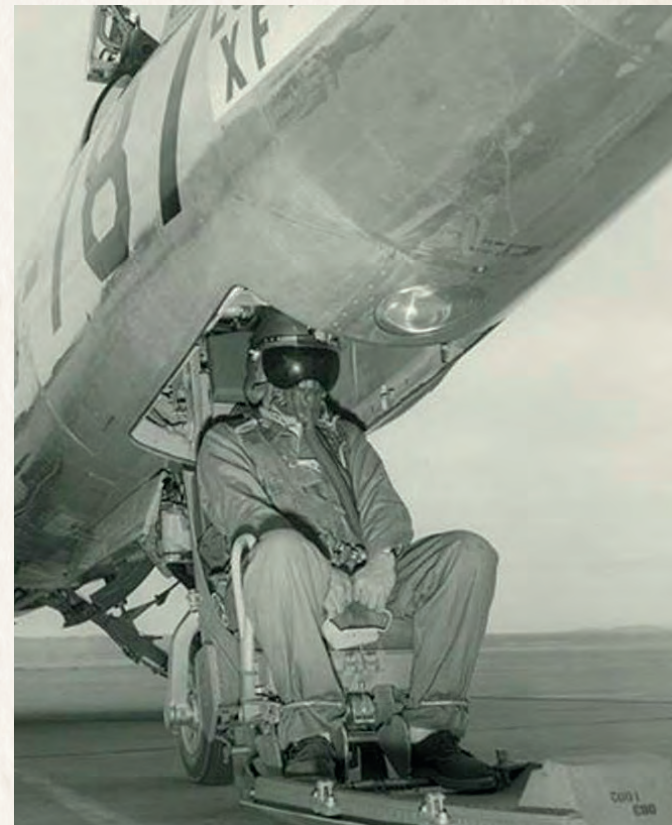
Eerste schietstoel van XF-104 en F-104A van Stanley Aviation Inc, die naar onder werd uitgeschoven.
